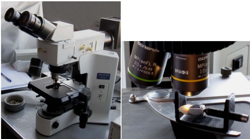
(الشكل 43): قصور منصة المجهر عن استيعاب العينة
