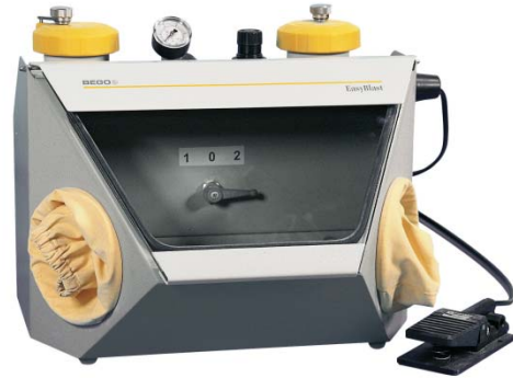
الشكل 19: مرملة ماركة EasyBlast
